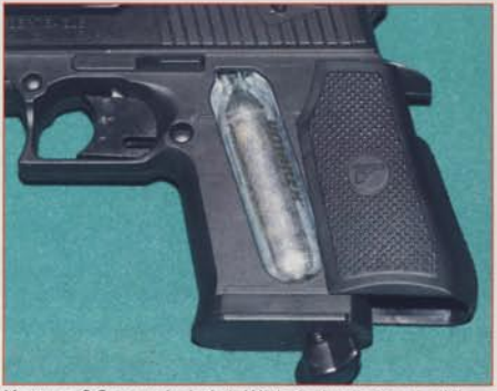
Kartusz CO2 w rękojeści. Widać aluminiowy szkielec, śrubę dokręcającą kartusz i odsuwane okładki.
