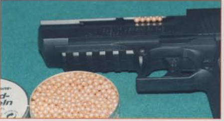
Ładowanie magazynka. Widać „rynnę” na śrut.
