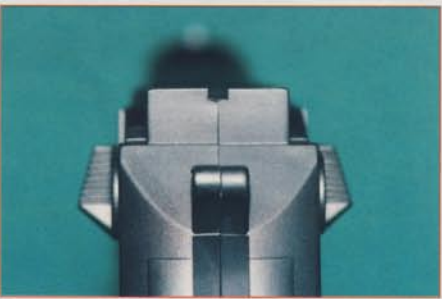
Szczerbinka. Widać niedokładne spasowanie połówek obudowy.
