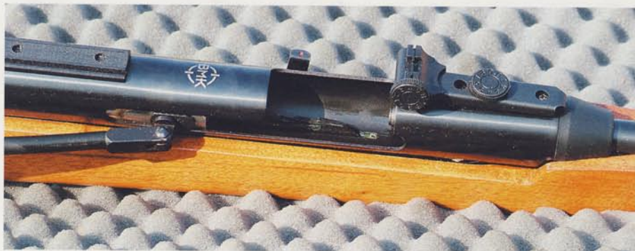
Dźwignia napinania sprężyny w tylnym położeniu – widoczna schodkowa listwa blokady tłoka, oraz przycisk (strzałka) do jej chowania
