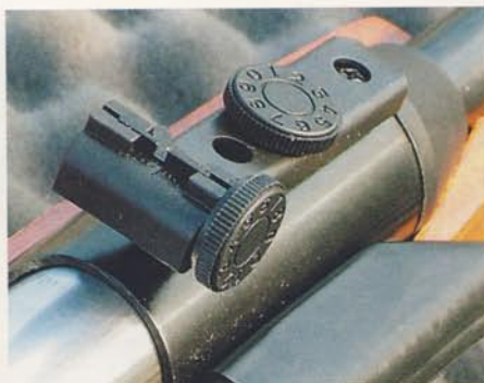
Mikrometryczny celownik wygląda tak sobie, ale działa dobrze – pokrętła regulacyjne są duże, wygodne w obsłudze i mają wyraźne „klikli”
