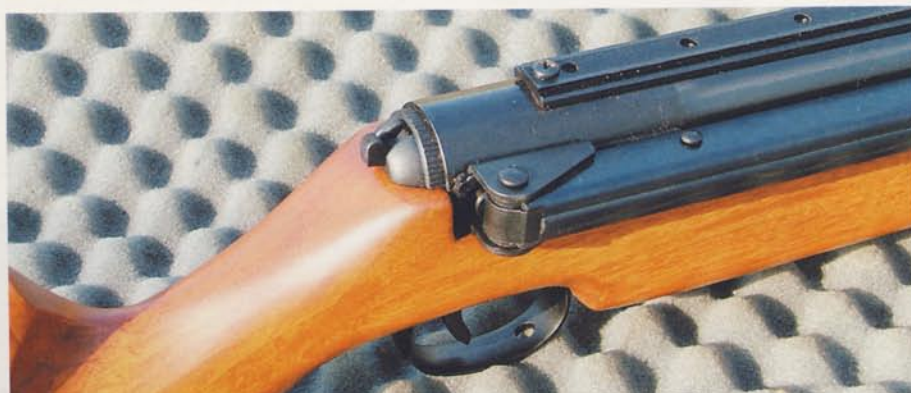
Na zdjęciu widać przycisk bezpiecznika, oraz szynę do mocowania celownika optycznego z otworami do stabilizowania lunety
