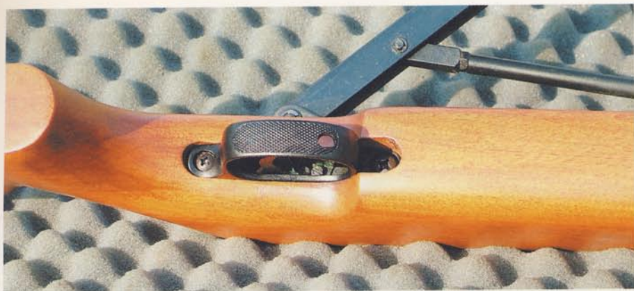
Regulacja spustu jest możliwa poprzez otwór w kabłąku – ale jeśli chcemy ustawić wszystkie parametry i sięgnąć do wszystkich wkrętów regulacyjnych, kabłąk trzeba odkręcić
